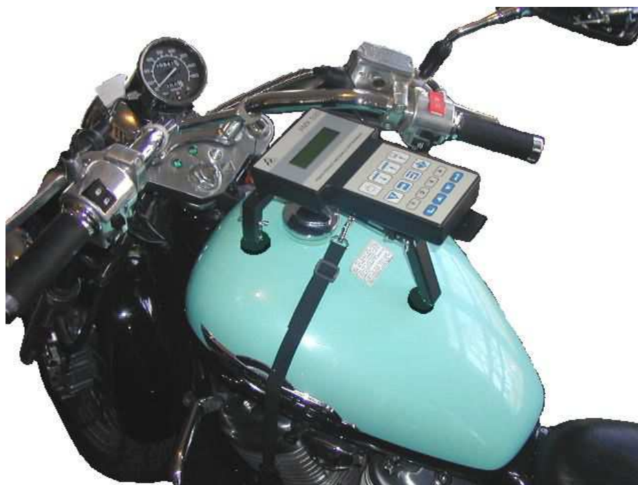
Rys. 8. Przyrząd AMX520/M prawidłowo zamocowany na motocyklu
