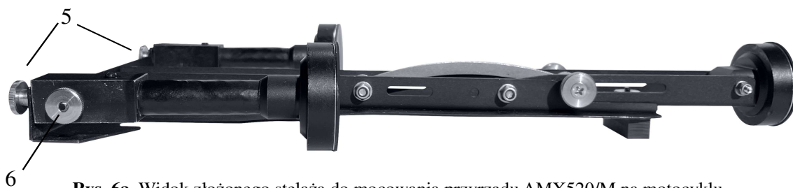
Rys. 6a. Widok złożonego stelaża do mocowania przyrządu AMX520/M na motocyklu
